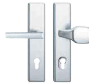
Sicura 12 (WK2) Sicura 35 (WK3) Sicherheitsdrücker (inkl. Kernziehschutz), Alu/Silber eloxiert oder Edelstahl matt. Auch für Feuerschutztüren geeignet.
